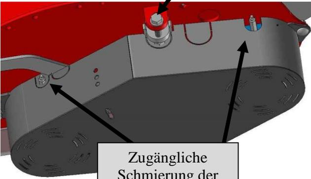
Zugängliche Schmierung der Rotorlager
